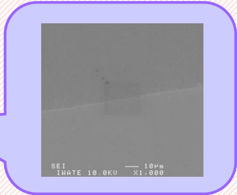
接合表面 SEM照片 1,000倍
